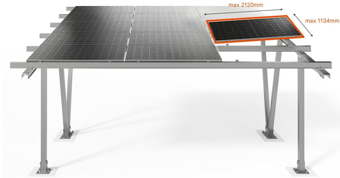
Carport przystosowany jest do montażu 15 modułów w układzie 5x3. Belka wzdłużna pozwala na zamontowanie 5 modułów o szerokości do 1134mm, natomiast belka poprzeczna na 3 moduły o długości do 2120mm.
