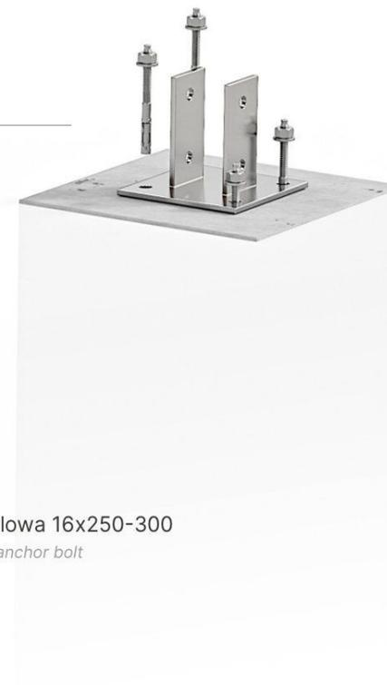
Do fundamentów przykręć stopy używając kotew  $\varnothing 16 \times 250-300$  i żywicy dwuskładnikowej. 8szt. na dużą stopę oraz 4szt. na małą.
