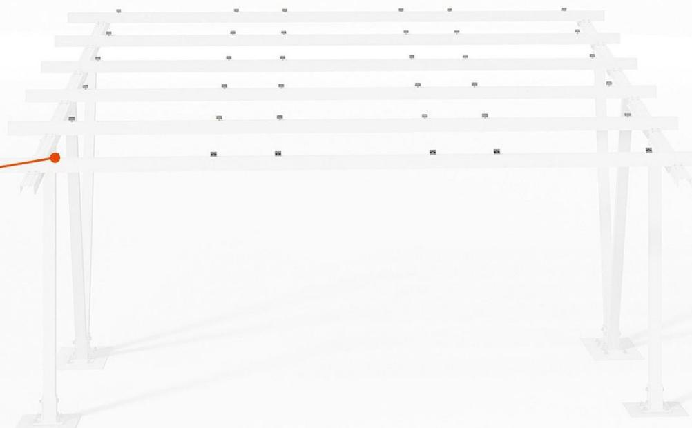
W górnym kanale profilu umieść wpust przesuwany. Wpust przesuwany konstrukcyjnie przystosowany jest do włożenia od góry w dowolnym miejscu kanału. Po rozmieszczeniu wpustów lekko przymocuj klemy za pomocą śrub imbusowych, klemy powinny luźno wisieć, zostaną one przykręcone w czasie rozkładania kolejnych modułów.
